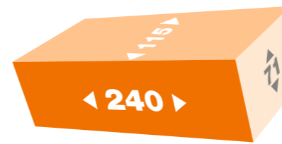
NF Normalformat 240 x 115 x 71 mm
