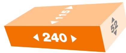
DF Dünndickformat ◀ 240 x 115 x 52 mm
