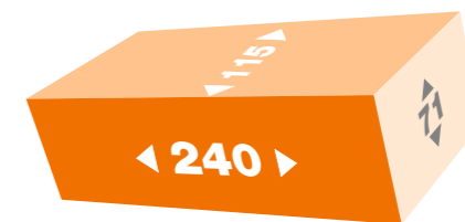
NF Normalformat ◀ 240 x 115 x 71 mm
