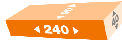
HF Hilversumformat 240 x 90 x 40 mm
